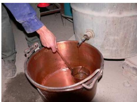
Fig. 23. La "testa" del distillato.
